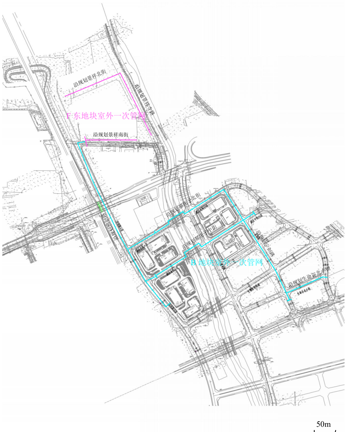
附图 4 室外一次供冷/供热管线平面布置图
